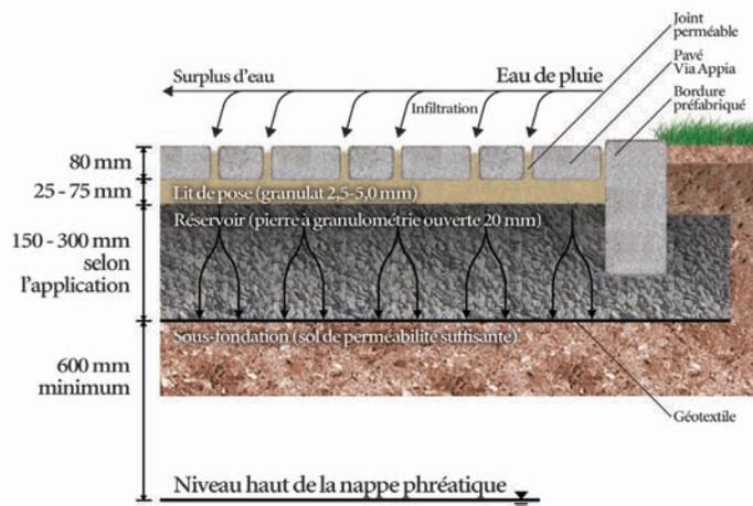
L'eau de ruissellement est dirigée vers le réservoir de pierre à granulométrie ouverte via les ouvertures (joints) du système de pavage. Le matériel utilisé pour le lit de pose des pavés de même que pour remplir les joints entre les pavés est une pierre de granulométrie ouverte de dimension 2,5 mm à 5,0 mm. L'épaisseur du lit de pose est généralement de 25 à 75 mm.
