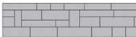
Modèle VI Muret composé à 50% de module 90 et 50% de module 135 avec modules verticaux
